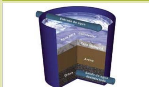
**El filtrado lento en arena desinfecta el agua y no requiere productos químicos ni instrumentación especial, consume poca energía y el mantenimiento es mínimo.**
