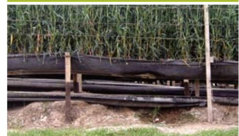
Figura 3 Acople para recoger los lixiviados de los canales plásticos
